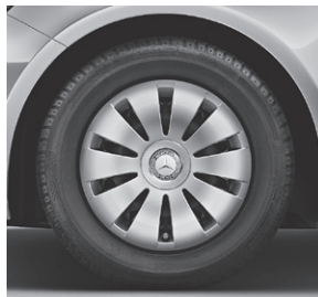
38,1 cm (15") Stahlrad mit Radzierblende im 10-Loch-Design (R00)
