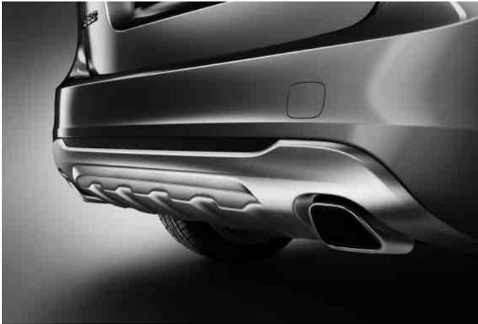
Heckschürzeneinsatz, Aluminium-Optik und Sport-Endrohre, Edelstahl poliert. Für Motorisierungen DRiVe und D3 ein Endrohr, für alle anderen Motorisierungen zwei Endrohre.
